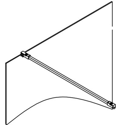
ILLUSTRATION SHOWS THE ARM IN A STRAIGHT PANEL TO WALL POSITION
