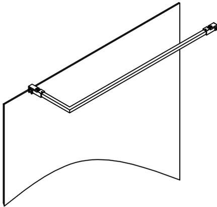
WHEN THE BRACKET IS IN POSITION RE-TIGHTEN ALL FIXING POINTS
