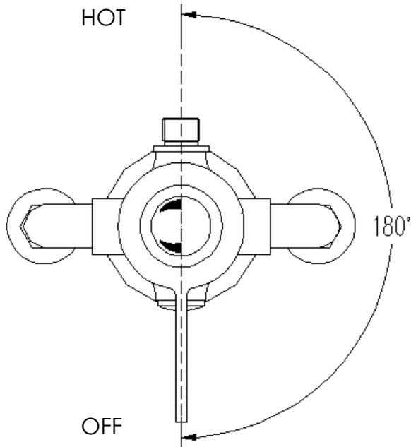
NOTE: THIS DIAGRAM DEPICTS A LEVER TYPE HANDLE BUT THE OPERATING PRINCIPLE IS THE SAME REGARDLESS OF THE HANDLE. THE ABOVE IS THE RECOMMENDED LEVER ORIENTATION.
