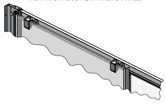
WHEN THE DOOR IS FITTED TURN THE ADJUSTER SCREW ON THE TOP ROLLERS TO LEVEL THE DOORS WITH THE MAGNETIC PROFILE AND MAKE THEM TRUE TO EACH OTHER.
